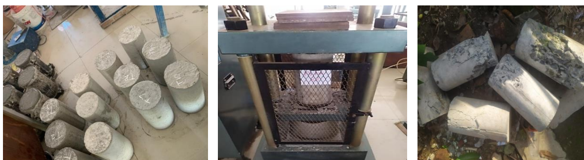
Tampilan Benda Uji Beton
