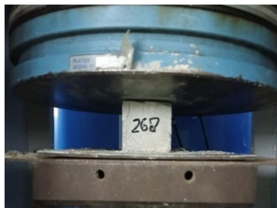
Gambar 8. Pengujian Kuat Tekan Mortar
