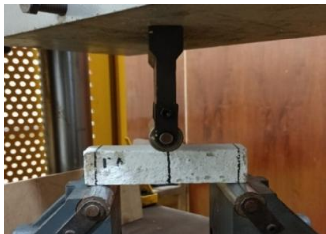
Gambar 14. Pengujian Kuat Lentur Balok Mortar
