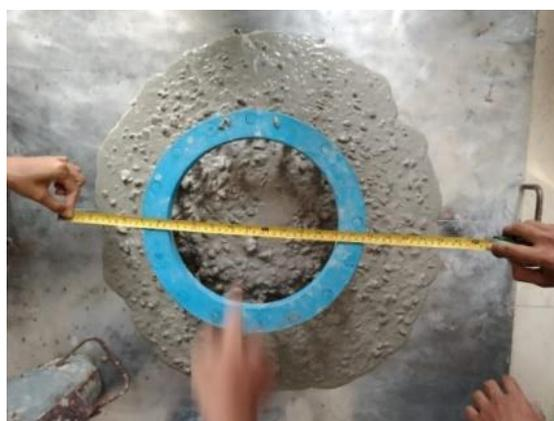
Gambar 5. Uji slump menggunakan J-ring Tester
