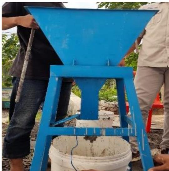
Gambar 7. Uji slump menggunakan V-funnel tester
