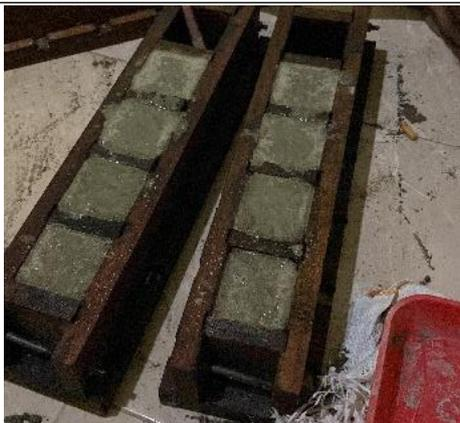
Gambar 2. Pembuatan benda Uji
