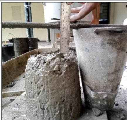
Gambar 4. Hasil Pengujian Slump
