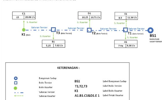
Gambar 7. Skema Irigasi Petak Tersier L1 TA Sunua Tengah
