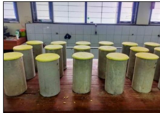
Gambar 12. Proses *Capping* Benda Uji
