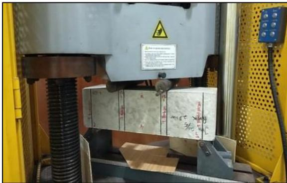
Gambar 11. Pengujian Kuat Lentur Beton
